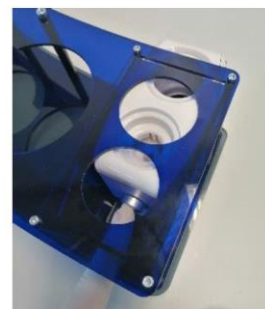
3) Retire el panel lateral tirando hacia arriba para sacarlo 4) Empuje el humidificador fuera de la carcasa
