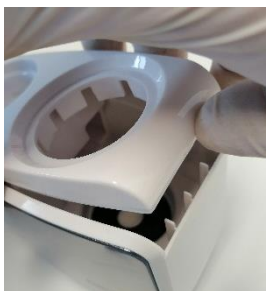
6) Otevřením víka zvlhčovače umožníte vyčištění jeho vnitřního prostoru.
