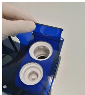
3) Odstraňte boční panel tím, že jej vytáhnete nahoru a vyjmete.
