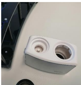
5) Vytáhněte zvlhčovač ze stojánu.
