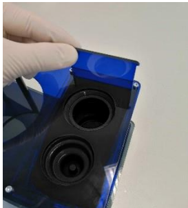
3) Retire el panel lateral tirando hacia arriba y sacando
