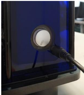
1) Desenchufe el cable de 24 V
