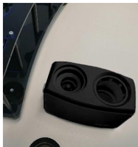
5) Extraiga el humidificador del soporte
