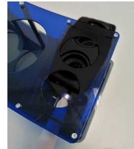
4) Sacar el humidificador de la carcasa
